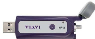
**MP-60**：USB接続の光パワーメータで、760~1650nmの範囲で校正波長1nm単位で設定・測定可能な手の平サイズのUSBパワーメータ。MP-60は最大+10dBmまで測定可能、MP-80は+23dBmまで。
