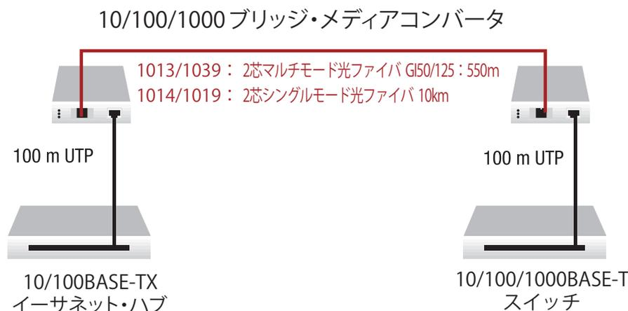
(2) 近端の PC は 1000BASE-T であるが、対向先の PC は 10/100/1000 のいずれかではあるが速度が不明である。この間を 10/100/1000 ブリッジ型メディアコンバータで延長する例：
