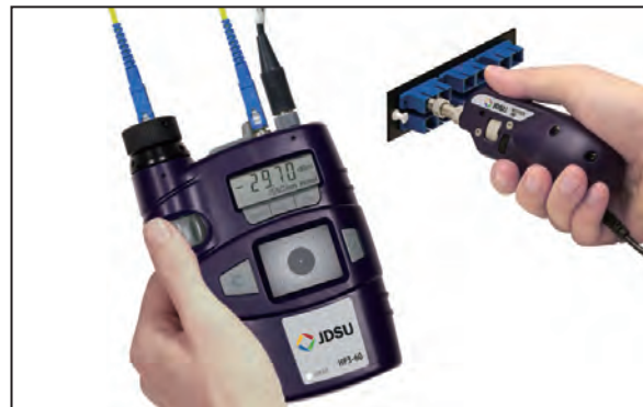
FBP/HD3-60-P4 光ファイバ端面検査装置 (光ファイバ・パワーメータ機能付き)
