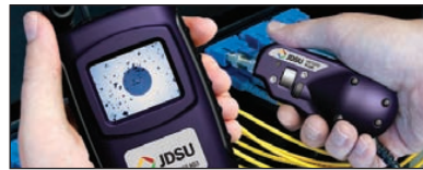
光ファイバ・コネクタ端面の確認
