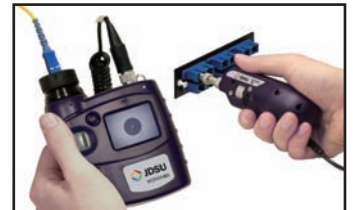
光ファイバ・パッチコード端面の確認も行えます。
