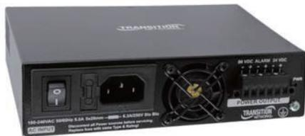
この単体型電源ユニットは、拡張温度環境でAC100~240V入力に対応し、デュアルDC電源出力を提供するように設計されています。コンパクトなフォームファクタで、DINレールに取り付けることができます。AC入力はC13/NEMA5-15pの電源ケーブル(PSE-JETマーク付)が標準付属で入力できます。
